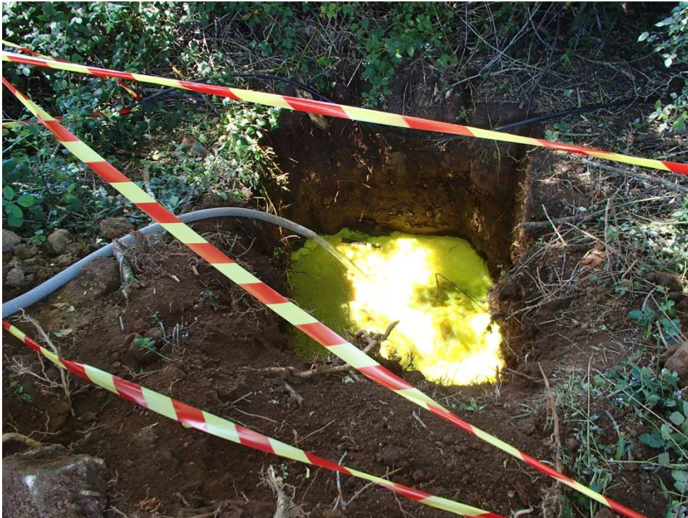
Photo 2 - Injection de 530 g de fluorescéine dans la fosse
