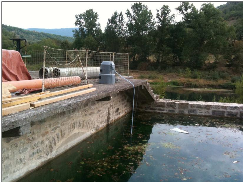
Photo 7 : Préleveur autonome installé à la sortie de la source de Douzes
