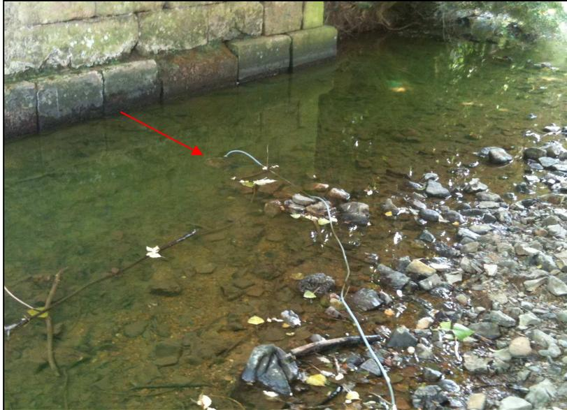
Photo 6 : Fluorimètre de terrain déposé dans la Muze à Gignac
