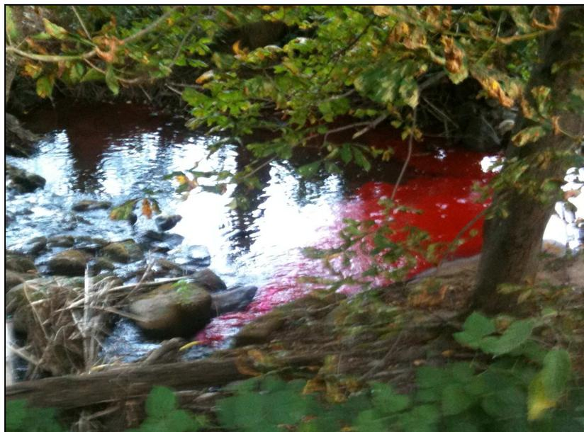
Photo 2 : Injection de la sulforhodamine en continu
