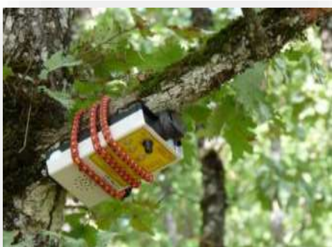
Figure 10 : Dispositif de suivi des chiroptères
