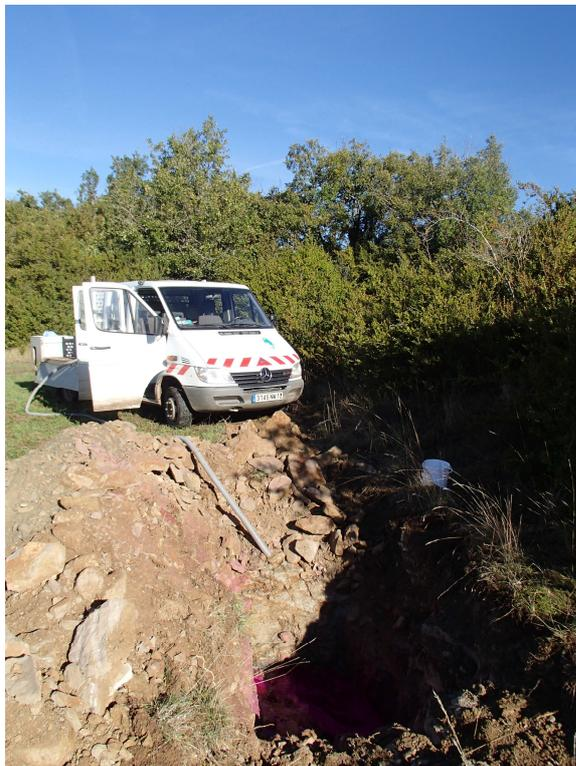
Injection le 17/10/2013 à 8h30 de 2kg de Sulfo B
